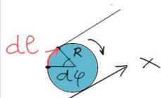
La rotazione  $d\varphi$  del cilindro fa avanzare il centro di Massa di un tratto  $dx = dl$ :
