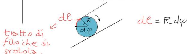
II. Per effetto della medesima rotazione  $d\varphi$  del cilindro il cilindro avanza lungo il piano inclinato di un tratto pari a  $dl$
